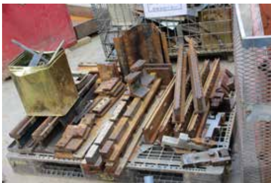
水没し、サビが発生した金型 (7/27)
